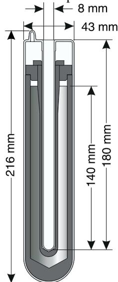
Figure 10. A mini cell in a salt bath.
