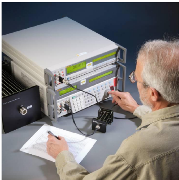
图 5 用 A40B 校准 5520A 校准器
