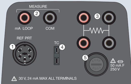
Panel -P(versi proses) adalah bagian pembacaan instrumen dan hanya tersedia dengan model -P.
