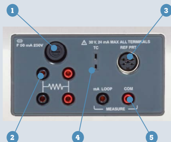
Model 6109A-P dan 7109A-P dilengkapi dengan Process Input Module yang mengukur berbagai tipe sensor suhu.
