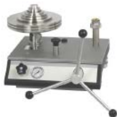
Gambar 2. Tester deadweight konvensional menghasilkan, mengontrol, dan mengukur tekanan hidrolik.
