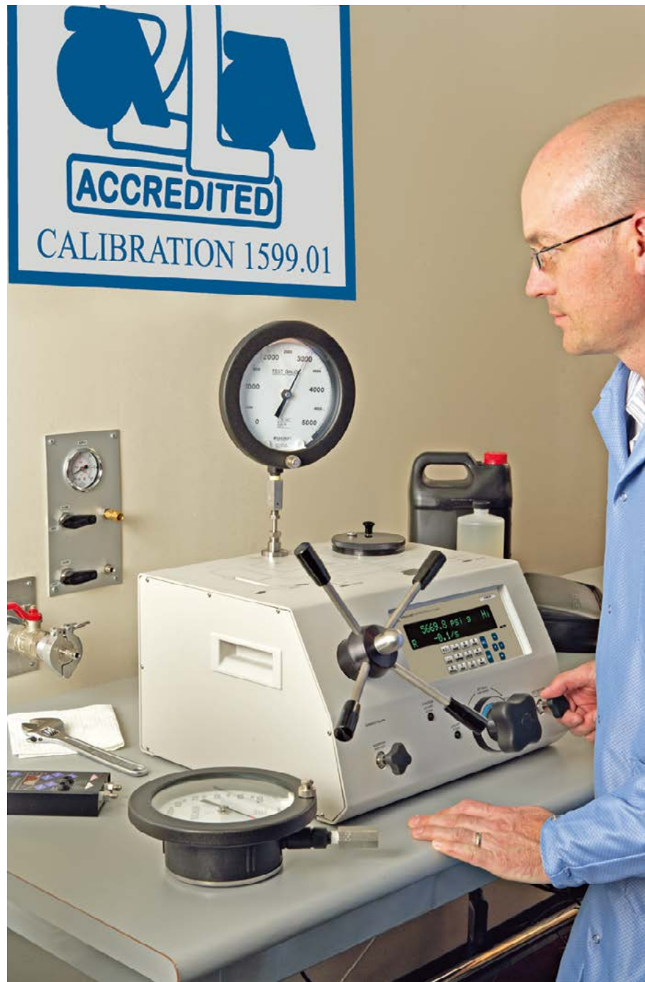
Valve fine adjustment E-DWT-H memungkinkan operator mengatur tekanan ke nilai nominal yang tepat pada pengukur yang sedang diuji.
