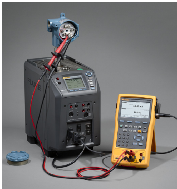
Рис. 5. Использование Fluke 754 и сухоблочного калибратора Fluke Calibration при калибровке передатчика 4-20 мА и датчика температуры.
