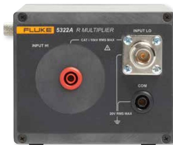
Cada 5322A vem com um multiplicador R externo para fornecer resistências de 10 TΩ para teste de verificadores de isolamento.
