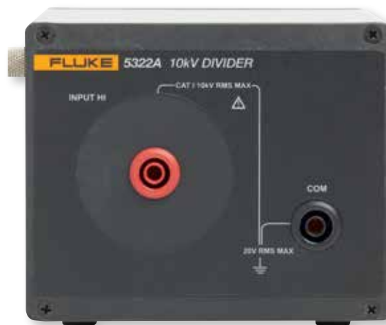
O 5322A inclui um divisor externo de 10 kV para medir verificadores com saídas de 10 kV.
