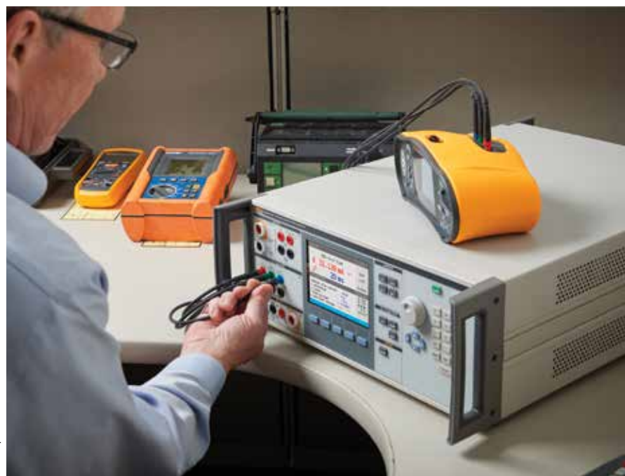
Cada 5322A vem com um multiplicador R externo para fornecer resistências de 10 TΩ para teste de verificadores de isolamento.
