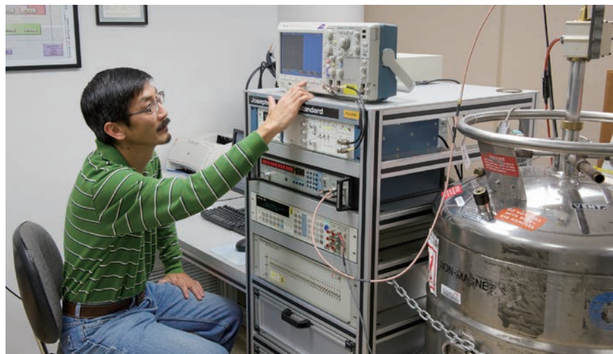
Das Fluke Calibration Standards Laboratory gewährleistet die Rückführbarkeit gemäß dem eigenen Josephson Array, das eine reproduzierbare Spannung durch Josephson-Tunnelelemente darstellt.
