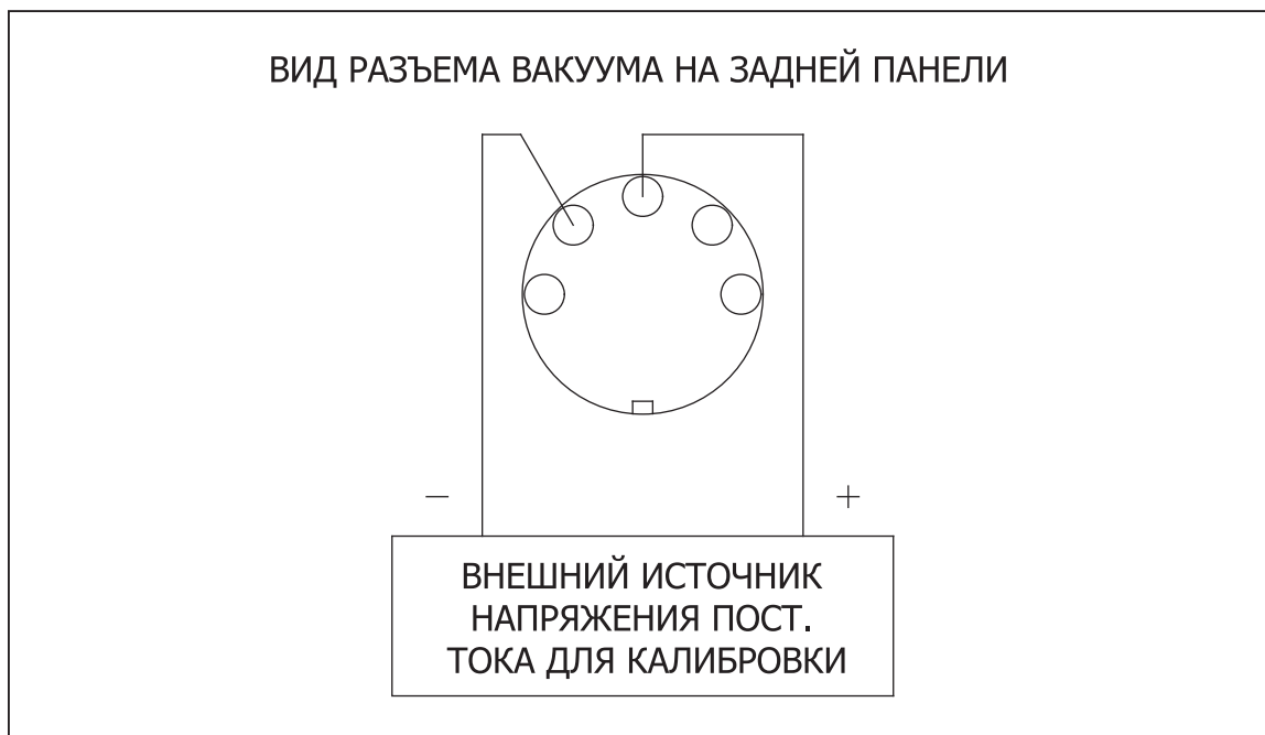
Рисунок 4. Подключения к разъему вакуума на задней панели для калибровки вакуумной цепи
