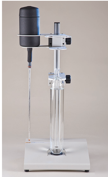
Рисунок 2. 2031-STND с 2031A и ячейкой температуры тройной точки воды
