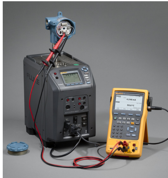
Abbildung 5: Der Kalibrator Fluke 754 und der Fluke Blockkalibrator kalibrieren einen 4–20 mA Transmitter und Temperatursensor.
